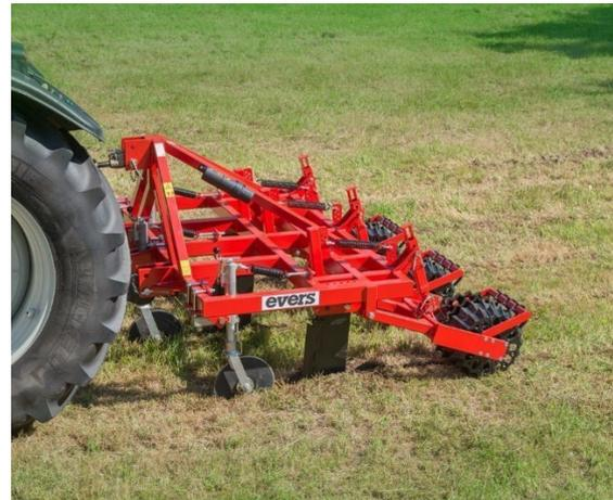
Abbildung 11: Europäische Alternative der Yeomans Plow, produziert durch die Firma Evers AG (Quelle: eversagro.de)
