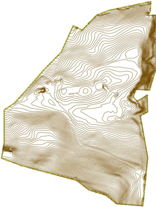
Abbildung 53: Höhenlinien auf Parzelle mit einheitlichen Abständen (0.5 m)
