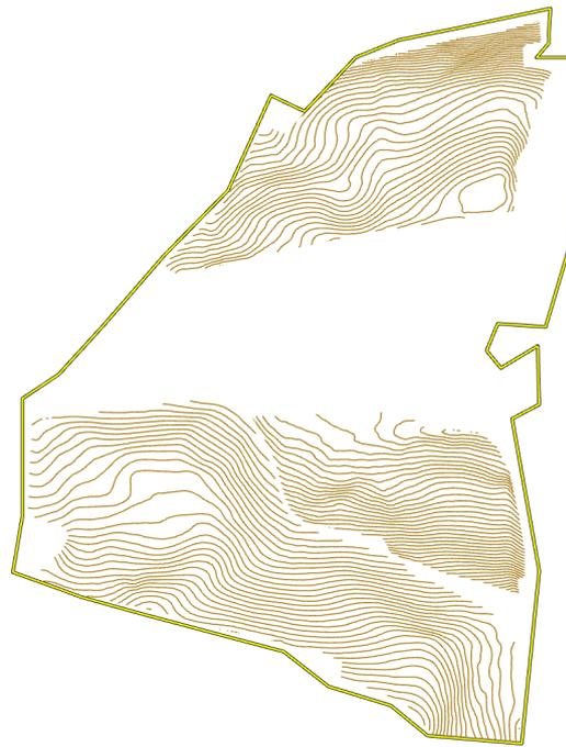
Abbildung 54: Höhenlinien mit unterschiedlichen Abständen (Feld 1 und 2: 0.5 m; Feld 3: 1 m)
