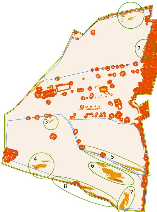
Abbildung 51: Markierung der Problemstellen mit Gefälle über dem Schwellenwert von  $20^\circ$
